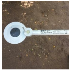
Figura 6.2. Radiómetro Kipp & Zonen Delft/Holland para medir la radiación neta.
