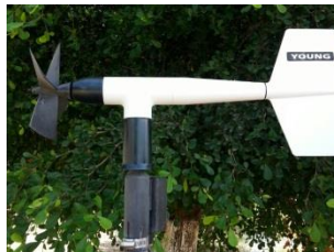
Figura 6.4. Anemómetro para medir la velocidad y dirección del viento.
