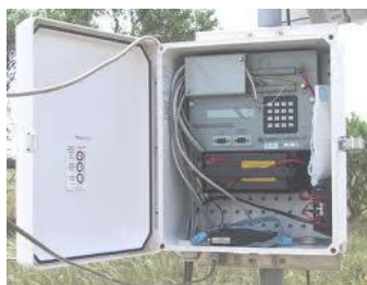
Figura 6.5. Datalogger Campbell sobre la estación meteorológica.
