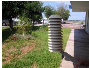
Figura 6.3. Sensor VAISALA para medir la temperatura.
